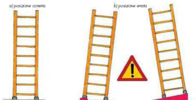
**Figura 6: corretto posizionamento e scorretti posizionamenti della scala**
