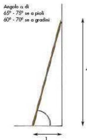
Fig. 29 - Corretta posizione della scala in appoggio
